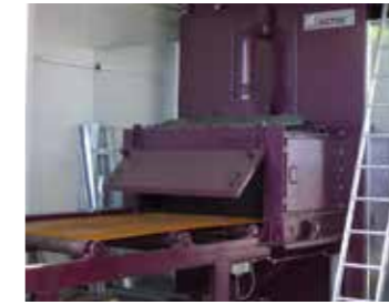
● 金属板材的抛丸机 Blast machine for metal sheets
