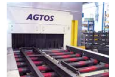
● 带有可调通过高度的抛丸机 Blasting machine with adjustable passage height
